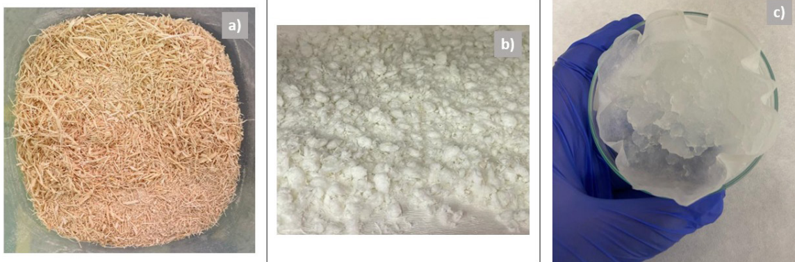
Figura 2. Evidencia visual del proceso HMM \rightarrow PHA \rightarrow TOCNF: (a) HMM sin tratar (tonos crema/marrón claro por presencia de lignina); (b) HMM delignificadas por PHA ( \text{H}_2\text{O}_2 10 % v/v, pH 11.5, relación biomasa:licor 1:2), con blanqueamiento por oxidación; (c) nanocelulosa obtenida por oxidación TEMPO
