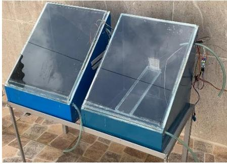
*Figura 1.* Destiladores solares con y sin condensación activa.
