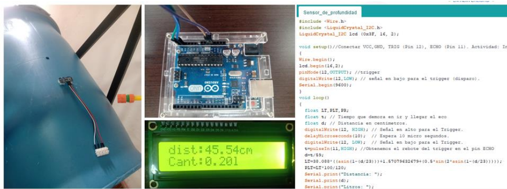
Figura 4. Simulación matemática para el cálculo de la cantidad de litros dentro del tanque cilíndrico.
