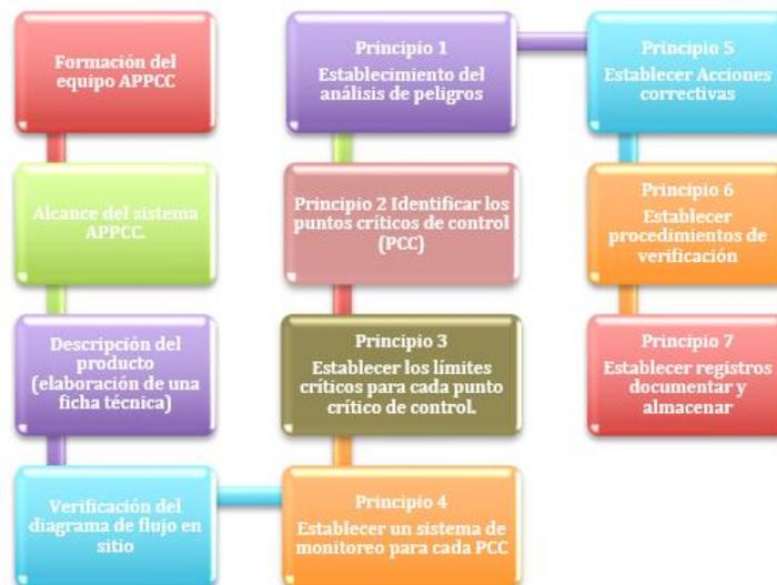
Figura 1. Secuencia de la aplicación de sistema APPCC. Fuente: elaboración propia (2019).
