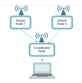
Figura 1. Diseño de red propuesto para una red inalámbrica industrial. Fuente: Kumbhar (2016).
