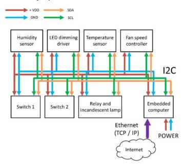
Figura 2. Ejemplo de arquitectura del protocolo de comunicaciones I2C. Fuente: Pintilie et al. (2019).
