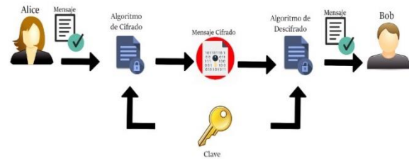
Fig 1 el proceso de un sistema criptográfico inicia con el mensaje sin cifrar los datos de este mensaje son cifrados a través de un algoritmo, una vez cifrado viaja por el canal ya codificado cuando llega al destinatario se descifra con la clave y se transforma nuevamente en el mensaje inicial sin cifrar. En la figura se utilizan los nombres de Alice y Bob para hacer referencia a un usuario A y B y el nombre Eve será usado para hacer referencia a un eavesdropper, una escucha, un espía que representa el usuario que intermedio que desea interceptar los mensajes enviados y es el objetivo principal a vencer en el cifrado de datos
