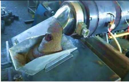
Figura 2. Boquilla de salida de extrusora, con mezcla de adoquines no convencionales.
