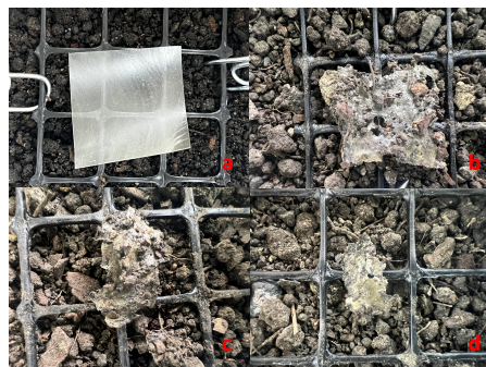
Figura 3. Imágenes de degradación en suelo de películas biodegradables F3: 1%AER. a) t : 0 días; b) t : 7 días; c) t : 14 días; c) t : 21 días
